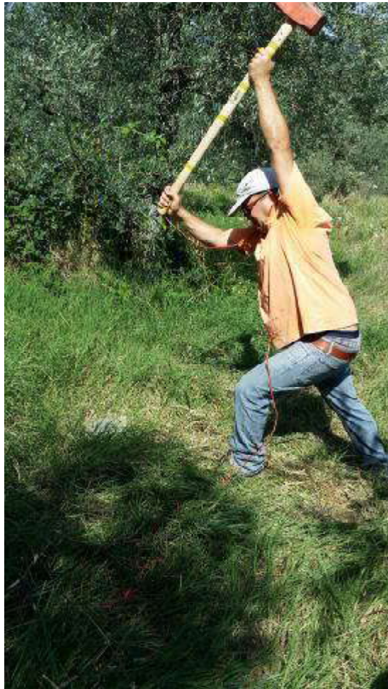
Particolare energizzazione onde di compressione profilo P2
