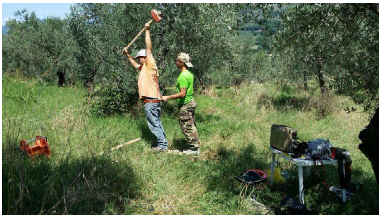
Particolare energizzazione onde di taglio per attrito radente profilo S2
