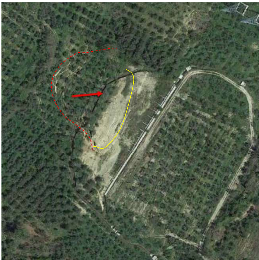
Situazione dell'area anno 2022 con la corona del movimento franoso a monte della paratia e la direzione del movimento
