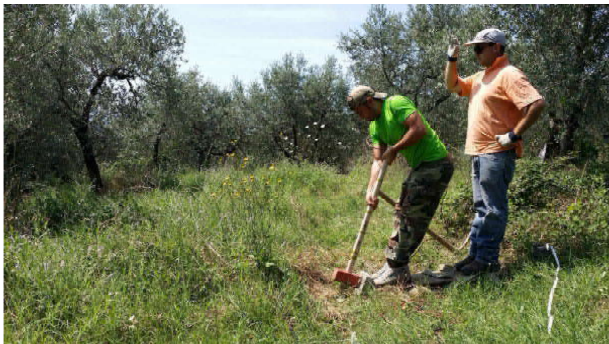
Particolare energizzazione onde di taglio per attrito radente profilo S1
