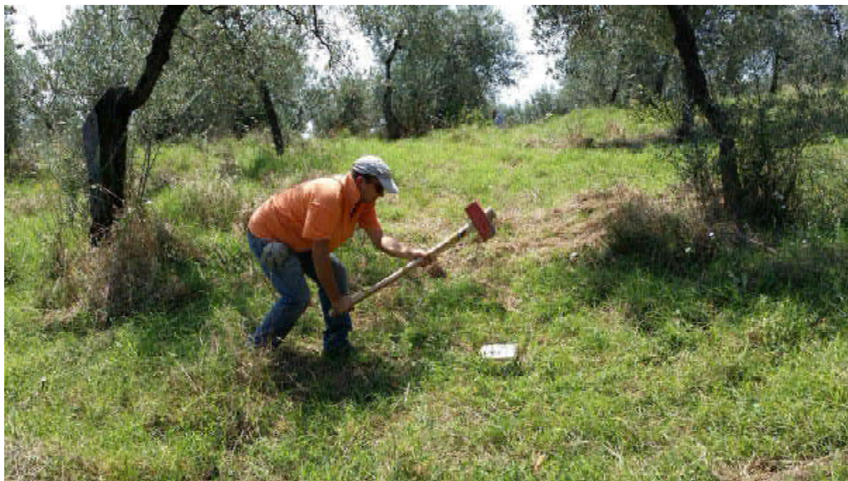
Particolare energizzazione onde di compressione profilo P1
